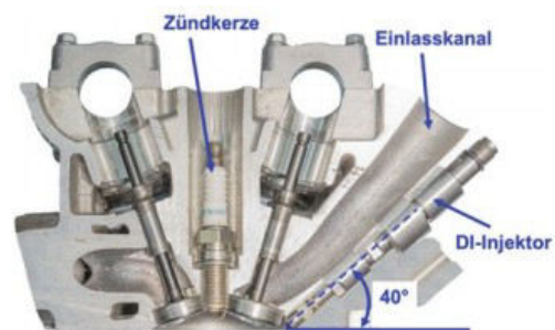
Abbildung 6: Darstellung der Injektorlage im geschnittenen Zylinderkopf [4]
