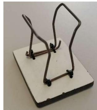
Abbildung 7 Kabelaufnahme aus Schweißdraht (1.5424)
