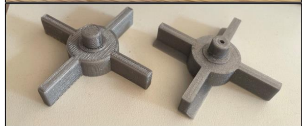
Abbildung 12: Apparatur zum Entfernen der Folie, unten verschiedene Geometrien der Schneide (links flach und gekerbt, rechts mit großem Schneidewinkel)
