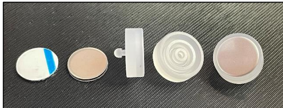
Abbildung 1: Tasteneinleger (links) und Tastenkörper (Mitte) in unterschiedlichen Ausrichtungen, rechts eine fertig verklebte Taste
